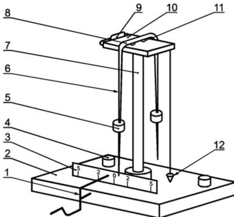
*1* - пусковой механизм; *2* - основание; *3* - шкала; *4* - установочные винты; *5* - груз; *6* - двустрелочный механизм; *7* - штатив; *8* - соединительная планка; *9* - рамка; *10* - столик; *11* - стальные шарики; *12* - отвес
